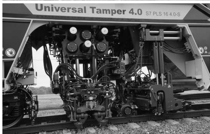
Podbijarka podczas pracy na linii nr 95.
